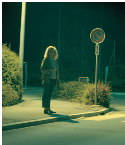
Abb. 11 (links): Gute Gesichtserkennung durch hohe halb- zyindrische Beleuchtungsstärke
