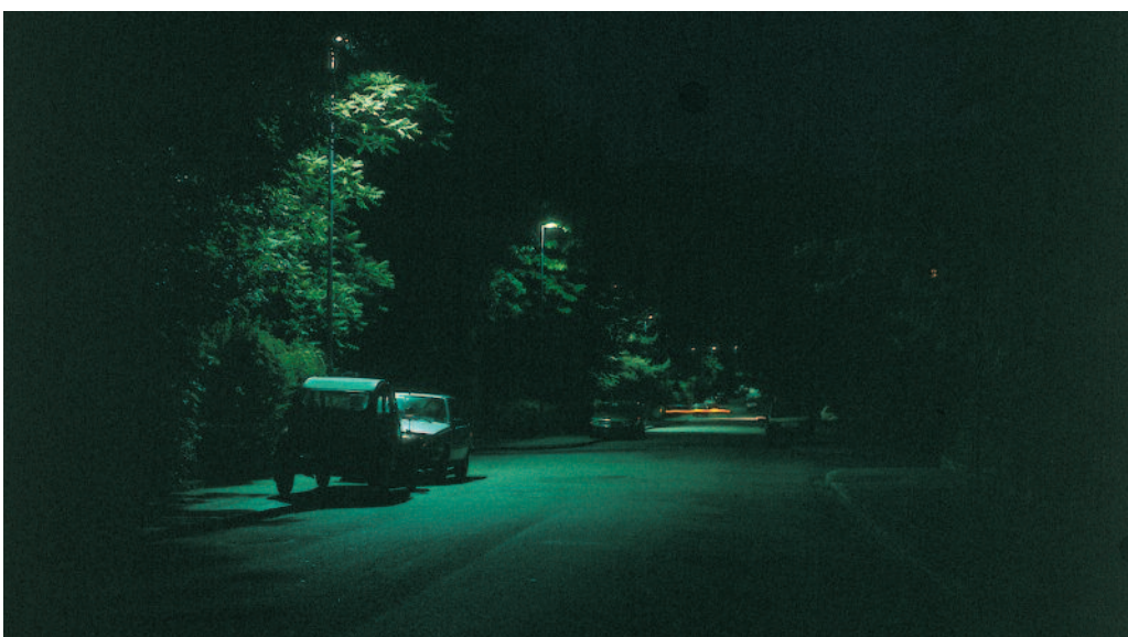
Abb. 6: Leuchtdichte und Gleichmäßigkeit der Leuchtdichte sind zu gering. Es sind nur kleine Teile des Verkehrsraumes erkennbar.
