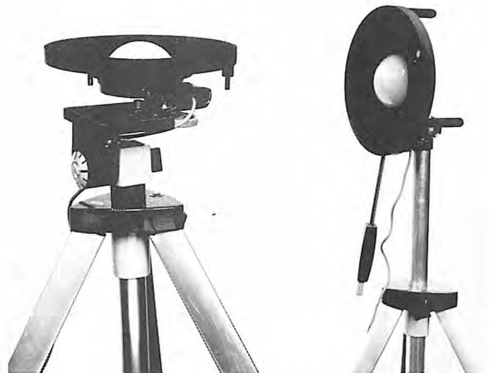
Bilder 5 und 6. Messung der Horizontalbeleuchtungsstärke (Bild links) und der Vertikalbeleuchtungsstärke (Bild rechts) mit Fotoelement und cos-Vorsatz auf Stativ
