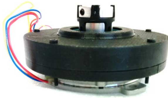
Abbildung 6: Erste Version der Aktor-Getriebe-Einheit (Gesamthöhe ohne Kupplung: 31 mm; Durchmesser: 83 mm; Gewicht 208 g)
