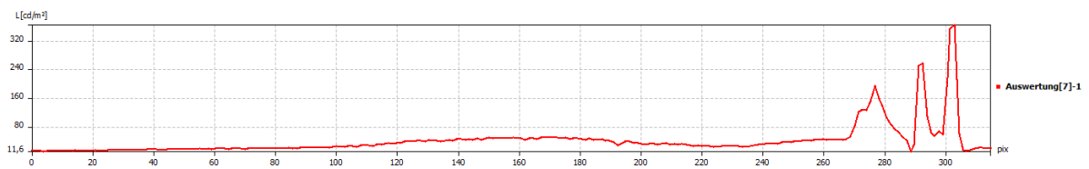
Abbildung 7. 20: Grauwertbildschnitt - Maximale Leuchtdichte L_{Max} = 364,8 \text{ cd/m}^2
