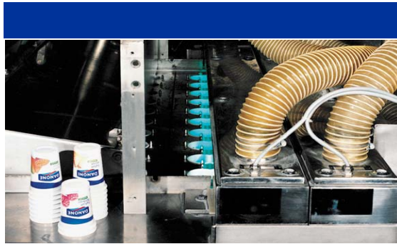
Abb. 3: Beispiel für Verpackungsentkeimung bei Joghurtbechern mit Hilfe eines UV-Entkeimungsmodus von Heraeus Noblelight
