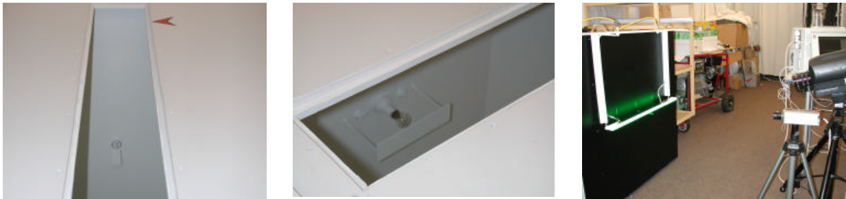
Bild 5 Integratorkiste mit Sensor, Überwachungs Lampe und Versuchsröhre bei Vermessung mittels Spektralmeßgerät und Leuchtdichtekamera
