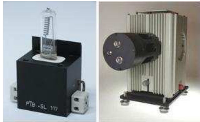
Abb.4: TransfERNormale für die spektrale Bestrahlungsstärke. Links: 1000 Watt Quarz-Halogen-Lampe, Rechts: 30 Watt Deuteriumlampe mit aufgesetztem Monitor-Detektor.
