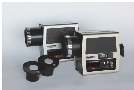
Abb. 2: Photopisch und skotopisch angepasste Beleuchtungsstärke- und Leuchtdichtemessgeräte der Firma LMT
