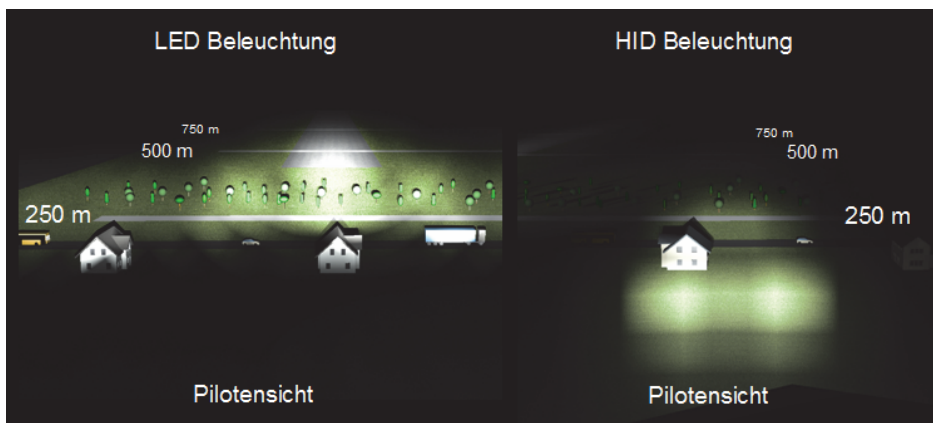
Vergleich der LED Lichtverteilung mit dem Stand der Technik in DIALux
