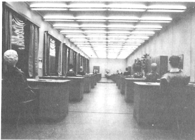
Bilder 1 u. 2: Modellräume, in denen Bewertungen der Blendung durchgeführt wurden.
