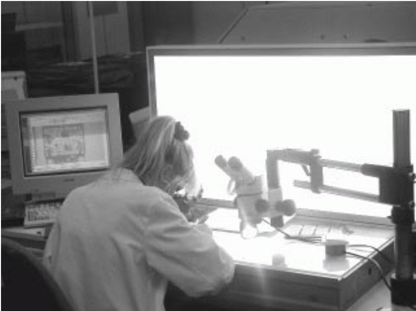
Abb. 3: Qualitätskontrolle von Leiterplatten mit Hellem Licht
