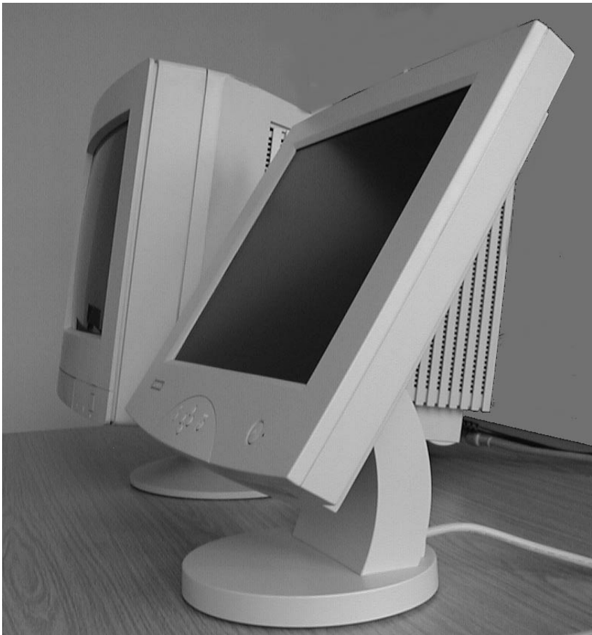
Abb. 3: Aufgrund ihrer Bauweise können LCD- und Kathodenstrahlbildschirme unterschiedlich weit nach hinten geneigt werden
