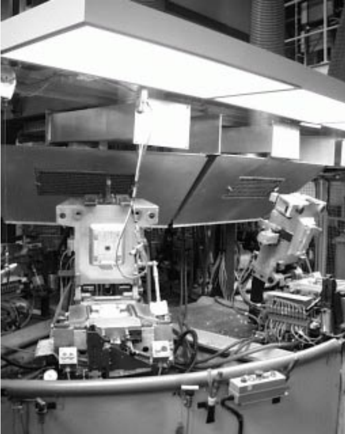
Abb. 4: Schäumenanlage für Kopfstützen mit Zirkadianer Licht-Technologie
