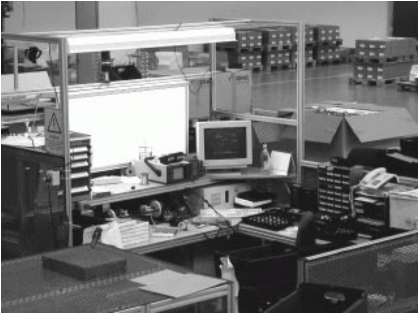
Abb. 5: Reparaturplatz für digitale Vorschaltgeräte mit Hellem Licht
