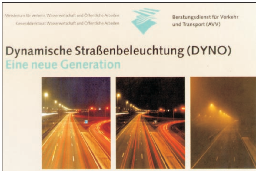
Figur 1: dynamisches Schalten von Autobahnbeleuchtung. Leuchtdichteniveau von links bis rechts 200 %, 100 % (1cd/m 2 ) und 20 %.
