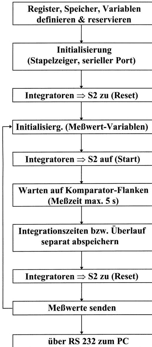
Bild 3: Vereinfachte Struktur der Betriebssoftware (Assemblerteil)
