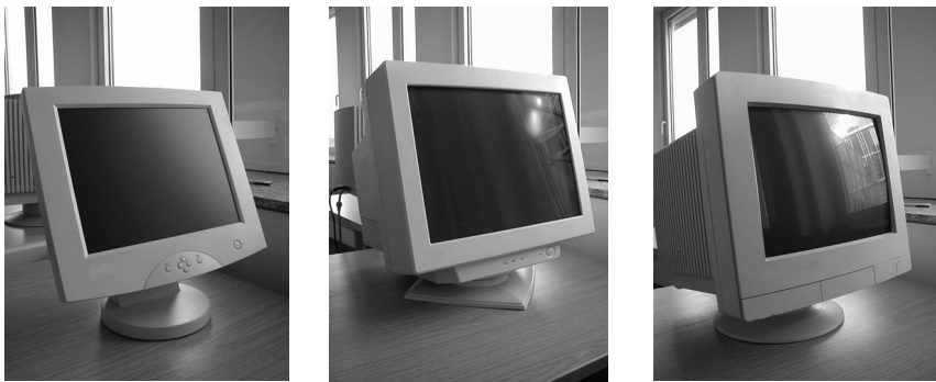
Abb. 2: Unterschiedlich gut entspiegelte Bildschirme klassifiziert nach DIN EN ISO 9241-7 (Ergebnisse der Prüfung Güteklassen Positivdarstellung/Negativdarstellung)
