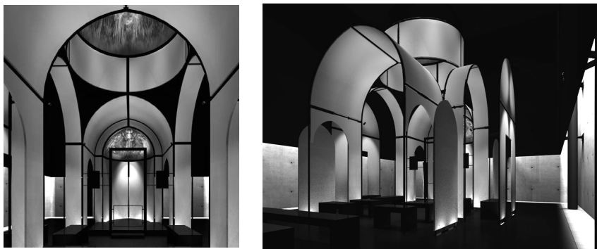
Abb. 3–4: Byzantine Fresco Chapel Museum (Simulation), Architekt: F. de Menil. Die realistische Lichtwirkung des gesandstrahlten Glases ergab sich zufällig durch eine physikalisch nicht nachvollziehbare Einstellung des Glas-Brechungsindex
